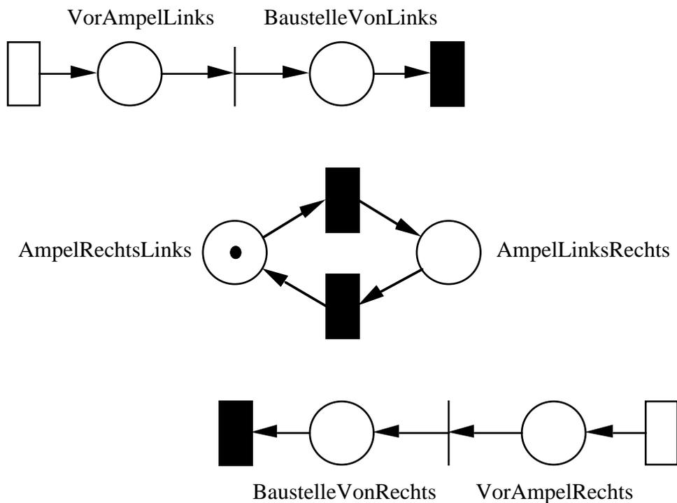
Der Verkehr von links nach rechts wird durch das obere Teilnetz mit den Stellen *VorAmpelLinks* und *BaustelleVonLinks* modelliert. Der Verkehr von rechts nach links wird
