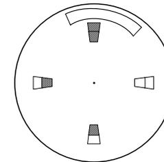
Über den Sensoren sind an der Unterseite der Scheibe Markierungen in Abständen von 90 Grad angebracht (siehe Abbildung). Wie im Bild skizziert, sind die Markierungen so angebracht, dass sich ein Rand der Doppelmarkierung genau in der Mitte des Schlitzes befindet.
