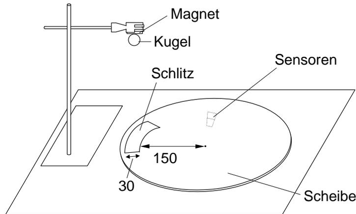
Die Scheibe hat einen Durchmesser von 400 mm und ist 17 mm dick; der Durchmesser der Kugel beträgt 12 mm. Der Schlitz ist 30 mm breit und 150 mm vom Scheibenmittelpunkt entfernt. Sein Öffnungswinkel beträgt 39 Grad. Fallhöhe  $h$  (gemessen von der Kugelunterseite bis zur Scheibenoberseite) und Drehgeschwindigkeit sowie -richtung der Scheibe können von Versuch zu Versuch variiert werden.
